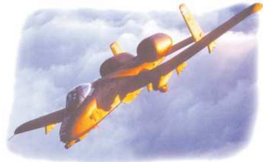
◀ FAIRCHILD A- 10 (ဖဲယားချိုင်းလ်အေ- ၁၀ တိုက်ခိုက်ရေးယာဉ်) (Fairchild A-10)လေယာဉ်ကို (Thunderbolt II) မိုးကြိုး (၂) ဟုလည်းခေါ်ကြ ပါသည်။ သို့သော်လည်း လေသူရဲများနှင့် လေတပ် တပ်ဖွဲ့ဝင်အားလုံးက ထိုလေယာဉ်ပုံကို (Warthog)ဟုလည်းခေါ်ကြပါသည်။ လေယာဉ်၏ဦးပိုင်း ထိပ်တည့်တည့်မှာ အလွန်စွမ်းအား ထက်သည့် (၃၀မမ GAU-8) အမျိုးအစား စက်အမြောက် တစ်လက် တပ်ဆင်ထားသည့်အပြင် တင့်ကားဖျက် ပဲ့ထိန်းဒုံးယာဉ်နှင့် ဗုံးများကိုလည်း သယ်ဆောင်နိုင်ပါတယ်။
