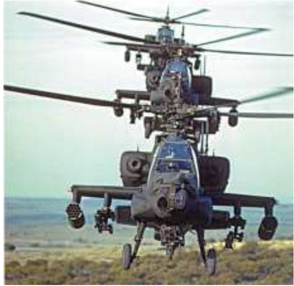
▼ APACHE (AH- 64- အပေချီ အမျိုးအစား တိုက်ခိုက်ရေး ရဟတ်ယာဉ်) အမေရိကန်တပ်မတော် ကြည်းတပ်သုံး အပေချီ တိုက်ခိုက်ရေးရဟတ်ယာဉ်ကို လေသူရဲနှစ်ဦး မောင်းနှင်နိုင်ပြီး တစ်နာရီကို ၃၆၅ ကီလိုမီတာနှုန်း ပျံနိုင်ခဲ့တယ်။
